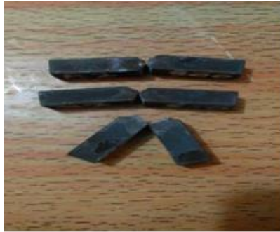
Gambar 11. Bentuk Patahan Uji Impak
